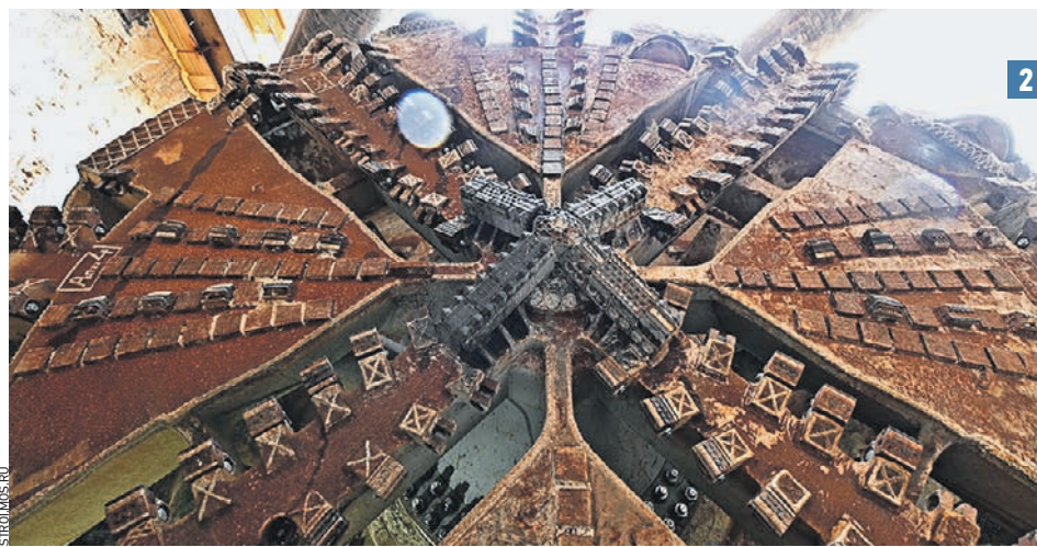
Тоннелепроходческий щит «Роза» будет использован при сооружении тоннеля от станции метро «Пыхтино» до «Расказовки» (2). Согласно проекту так будет выглядеть станция Калининско-Солнцевской линии подземки «Внуково» (1)
